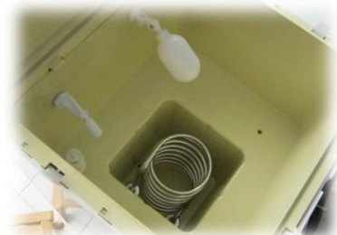
ถังน้ำเย็นใช้วัสดุ Food grade
